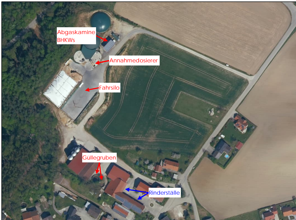
Abbildung 10: Luftbild mit Darstellung der Emissionsquellen der Rinderhaltung und der Biogasanlage /19/
